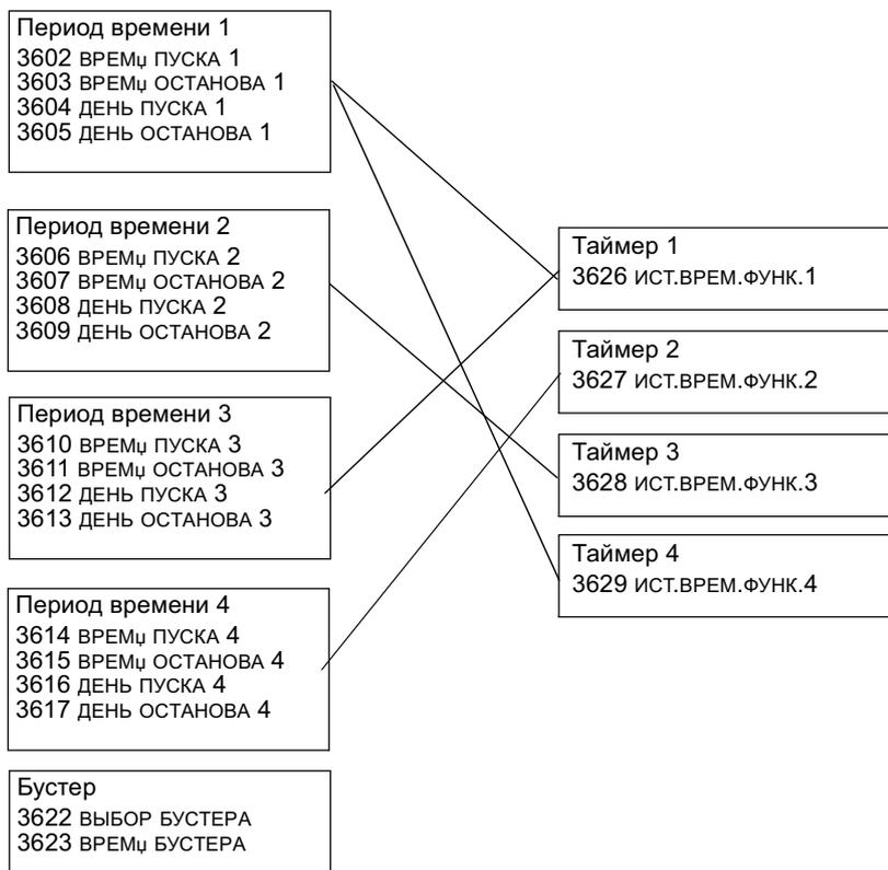
Параметр может быть связан только с одним таймером.
