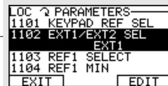
**Примечание.** Текущее значение параметра отображается под выделенным параметром.
