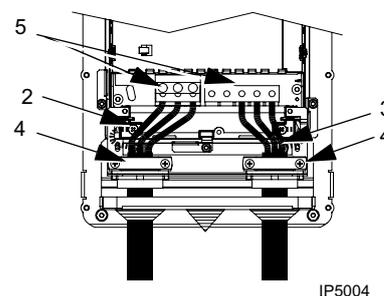
**Примечание.** Для приводов типоразмера R5 минимальное сечение силовых кабелей  $25 \text{ мм}^2$  (4 AWG).
