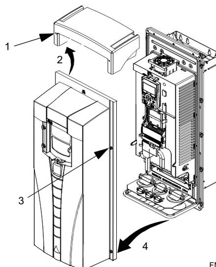
**Монтаж привода***IP 21 /UL тип 1*
