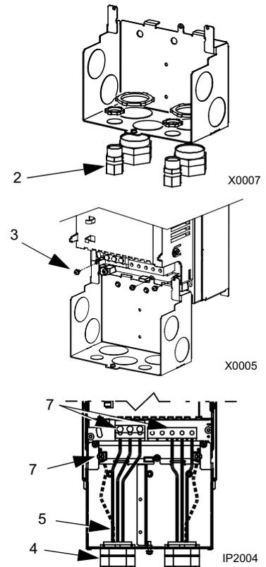
**Примечание.** Для приводов типоразмера R5 минимальное сечение силовых кабелей  $25 \text{ мм}^2$  (4 AWG).
