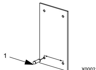
**Примечание.** В корпусах типоразмеров R3 и R4 предусмотрено четыре отверстия вдоль верхней стороны. Используйте только два из них. Если возможно, используйте два крайних отверстия (в этом случае остается пространство для демонтажа вентилятора при техническом обслуживании).
