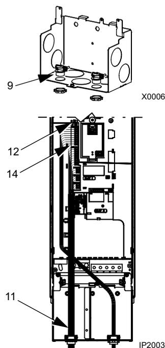
Подсоединение приводов в корпусах **IP 21 / UL тип 1** с помощью **кабельных каналов**
