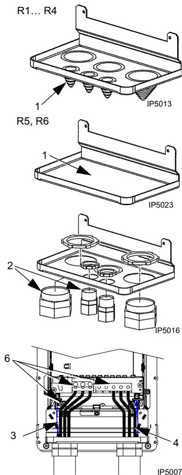
**Примечание.** Для приводов типоразмера R5 минимальное сечение силовых кабелей  $25 \text{ мм}^2$  (4 AWG).
