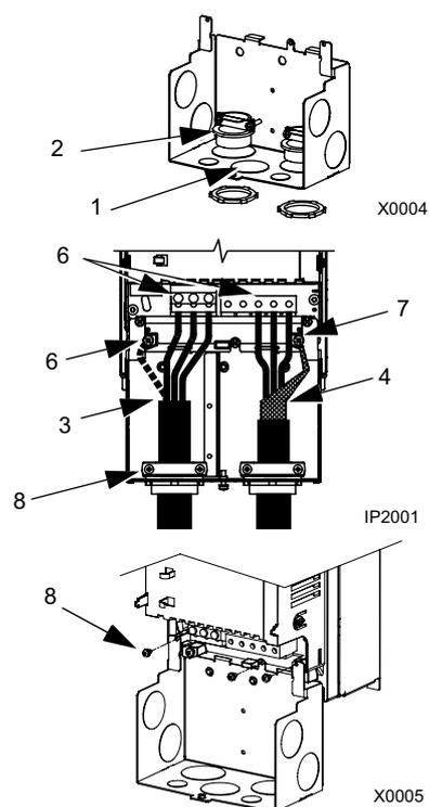
**Примечание.** Для приводов типоразмера R5 минимальное сечение силовых кабелей 25 мм<sup>2</sup> (4 AWG).
