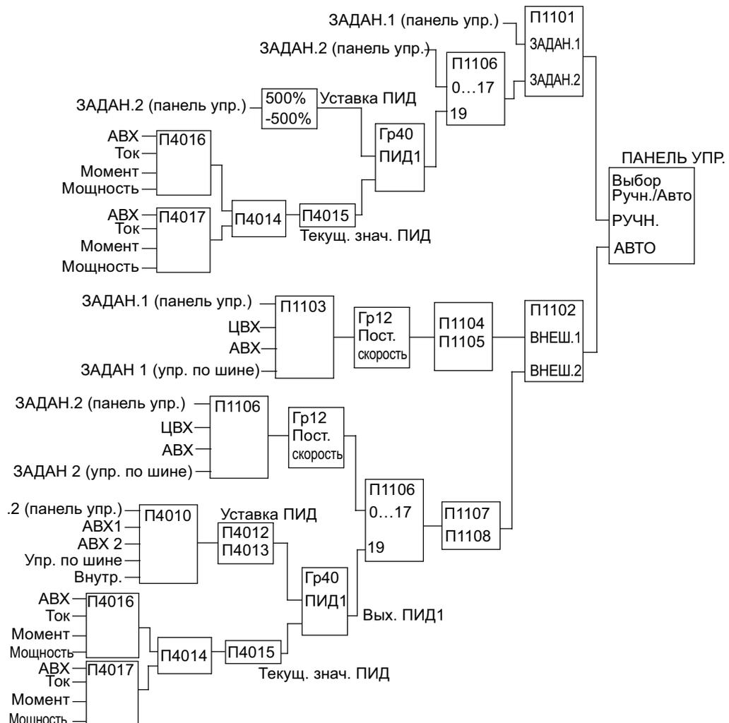
**Примечание.** Для того чтобы включить и использовать ПИД-регулятор, значение параметра 1106 следует установить равным 19.
