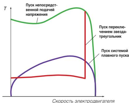
На графиках показаны основные отличия между пуском непосредственной подачей напряжения (DoL), пуском переключением звезда-треугольник и пуском системой плавного пуска в отношении напряжения на электродвигателе (V), тока электродвигателя (I) и его крутящего момента (T).
