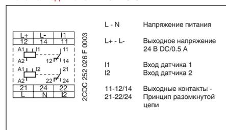
Подключение 2-проводных датчиков
