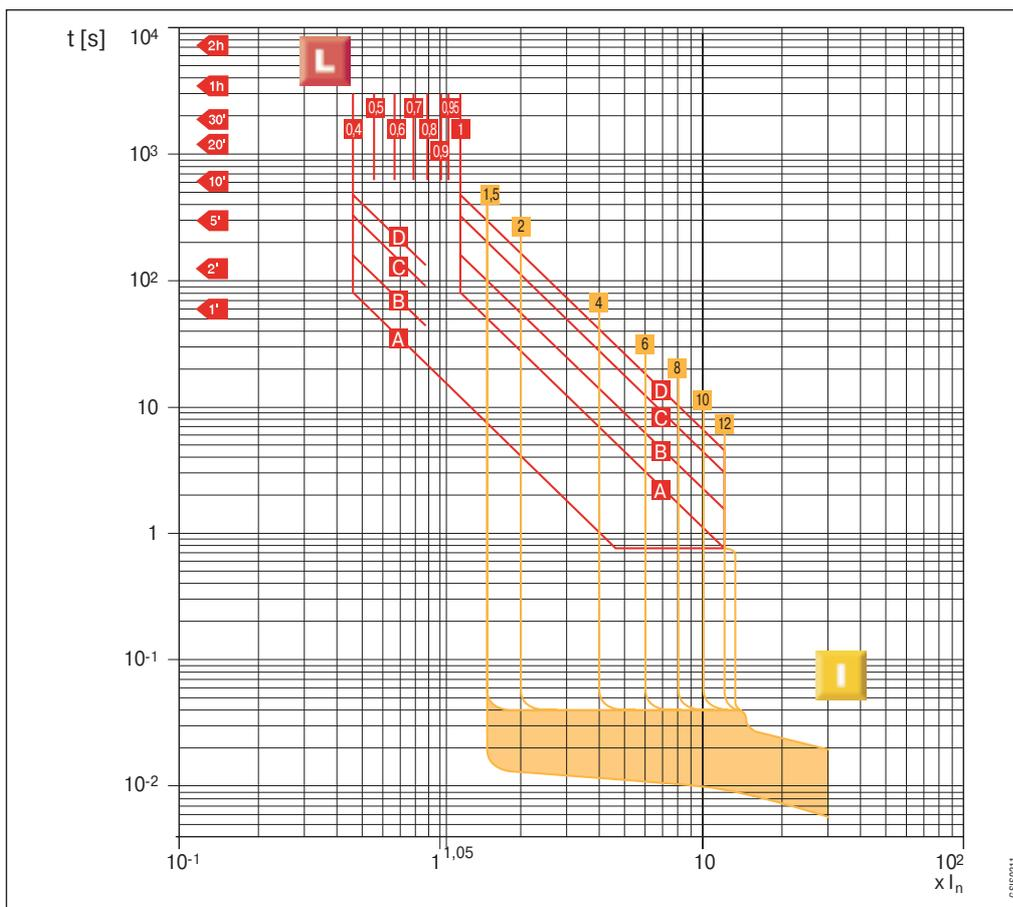
с электронным расцепителем SACE PR212/P (функции LSI).
