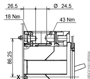
Выводы для подключения спереди медных/алюминиевых кабелей Cu/Al 2x240 мм<sup>2</sup> - FC CuAl
