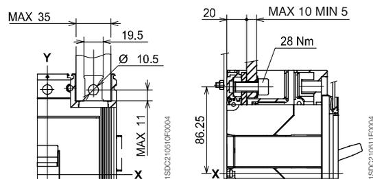
Выводы для подключения спереди медных кабелей - FC Cu
