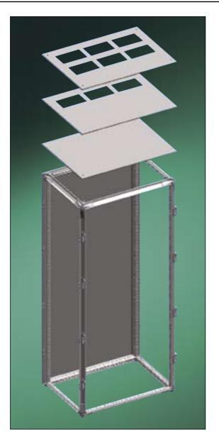
Верхние панели с нанесенным изнутри слоем губчатого материала обеспечивают степень защиты до IP 54. При креплении верхних панелей винтами или транспортировочными рымболтами достигается равномерное прижатие профиля TriLine-R, благодаря чему обеспечивается необходимое уплотнение. Имеются сплошные верхние панели и панели с отверстиями для установки сальников.
