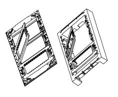
3. Los mecanismos se insertan por presión en el bastidor.
