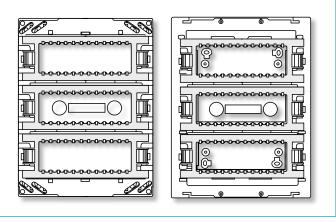
2. Tanto en la solución de superficie como en la solución empotrada, se disponen de unos bastidores metálicos abatibles donde se insertan los mecanismos.
