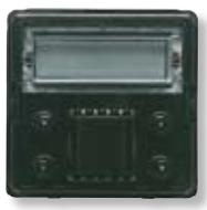
Termostato digital. | <b>8140.5</b> | 230V~ / 50Hz.<br>Salida libre de tensión (NA)<br>Carga máxima: 3A cos φ = 0,5.<br>Modos de actuación:<br>1) Histeresis: 0,50C<br>2) Ancho de pulsos: ±40C respecto a la temperatura de consigna.<br>Temperatura de uso: De 00C a 500C. Consumo <1W |                                                                                     | Tapa para termostato digital. | <b>2240.5</b> | <b>BA<br/>BM</b> |
