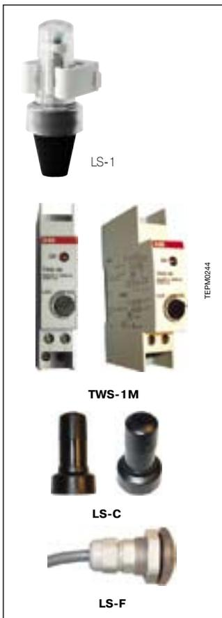
Реле используется для включения и/или выключения освещения в соответствии с установленным уровнем освещенности окружающей среды. Оно работает вместе с фотоэлементом, который формирует сигнал, соответствующий уровню освещенности. Прибор может выпускаться в исполнении со встроенным реле времени, что позволяет включать и отключать нагрузку через заданное время в зависимости от уровня освещенности. В комплект всех приборов TWS входит датчик освещенности для настенного монтажа (LS-1).
