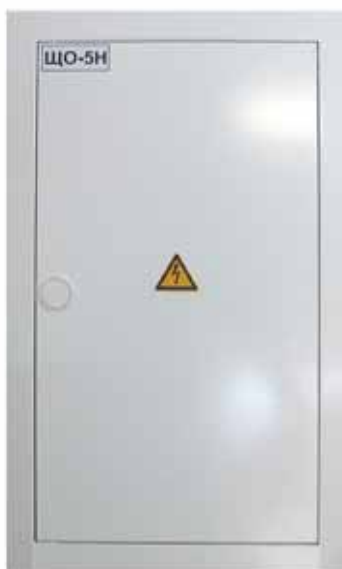
Внешний вид (ВхШхГ), мм -стенная ниша 585x350x95 -вырез в стене 558x327x88
